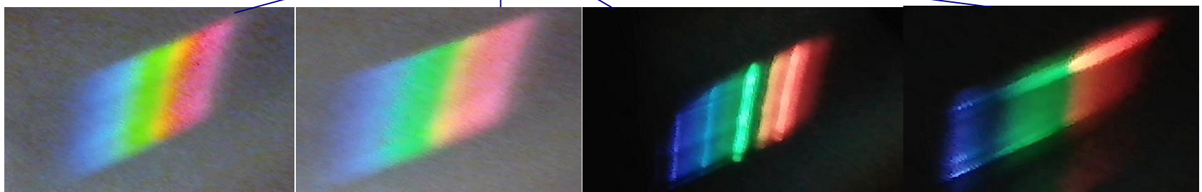
Γραμμικό Φάσμα λαμπτήρα φθορισμού λευκού φωτός, αυτό αποτελείται από πολλές χαρακτηριστικές γραμμές σε όλα σχεδόν τα χρώματα του ορατού φάσματος
