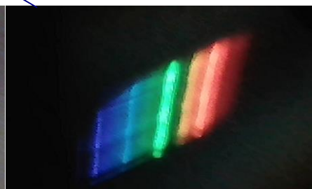
Γραμμικό Φάσμα λαμπτήρα φθορισμού λευκού φωτός, αυτό αποτελείται από πολλές χαρακτηριστικές γραμμές σε όλα σχεδόν τα χρώματα του ορατού φάσματος
