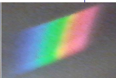
Συνεχές φάσμα λαμπτήρα αλογόνου λευκού φωτός. Αποτελείται από όλα τα μήκη κύματος του ορατού φωτός και ταιριάζει πολύ καλά στο φυσικό φως του ήλιου.
